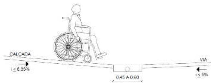
Ainda quanto ao desnível, salienta-se que as dimensões apresentadas nos desenhos consideram a altura padrão de meio-fio de 0,15m; assim, se o meio-fio possuir nível diferenciado deste, as dimensões devem variar a fim de respeitar a inclinação determinada na NBR 9050/ 2015.
